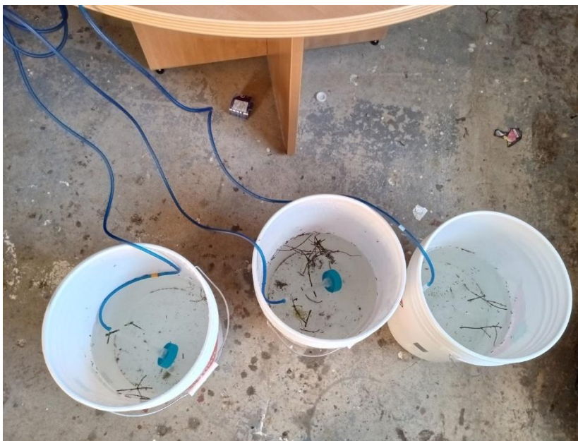
Fig. 4.2 Filtration de la neige fondue directement dans les seaux
